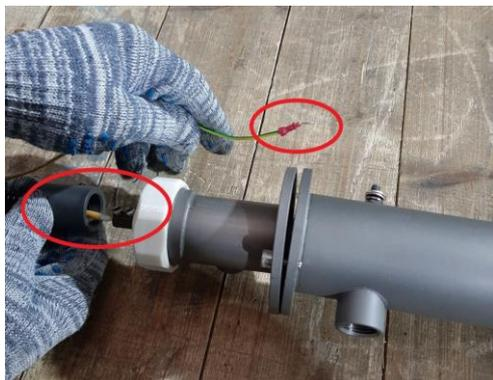
3. Открутите фиксирующие винты на клемме высоковольтного ввода:
