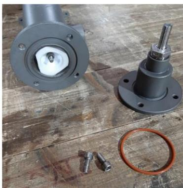
7. Извлеките трубку с электродом, потянув за его конец – при сильном обрастании окислами может потребоваться дополнительное усилие с другой стороны трубки:
