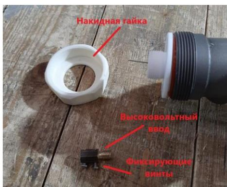
5. Открутите винты крепления верхней фланцевой заглушки, снимите ее вместе с пластиковой вставкой и кольцевым уплотнением:
