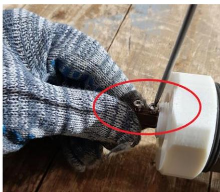
4. Открутите фиксирующую гайку. Выкрутите шестигранную клемму высоковольтного ввода:
