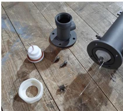
6. Открутите винты крепления нижней фланцевой заглушки генератора озона, снимите ее вместе с кольцевым уплотнением:
