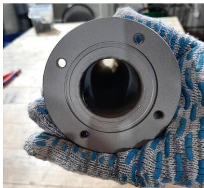
**Внимание! При сильном обрастании необходима очистка и восстановление электрода – для этого потребуется длительное замачивание трубки с электродом в растворе концентрированной кислоты. В этом случае производить очистку самостоятельно не рекомендуется – обратитесь в техническую поддержку производителя для проведения сервисных работ.**
