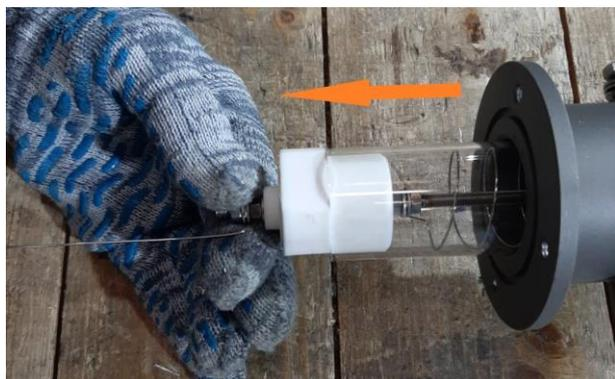
8. После извлечения трубки необходимо очистить ее внешнюю поверхность, а также внутреннюю часть корпуса генератора от окислов в растворе сильной кислоты (например, соляной).
