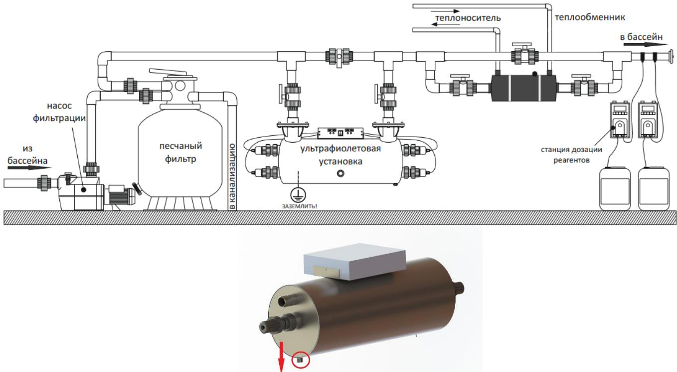
**ВНИМАНИЕ!! Монтаж установки осуществлять сливным отверстием вниз, подающие патрубки в верхнем расположении. В противном случае возможно завоздушивание корпуса и возникновение риска коррозии!**
