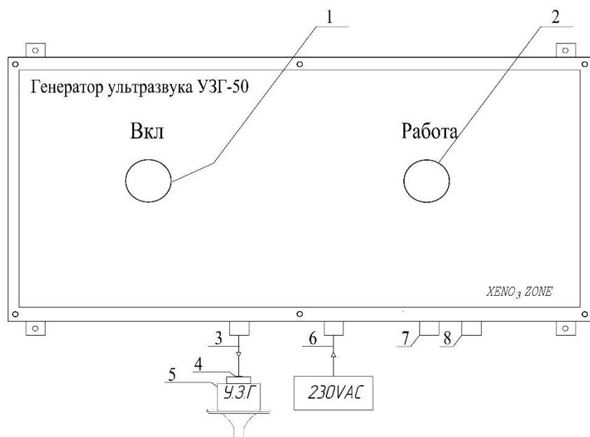
Для подключения генератора присоедините головку УЗ-преобразователя к корпусу УФ-установки, закрутив по резьбе:
