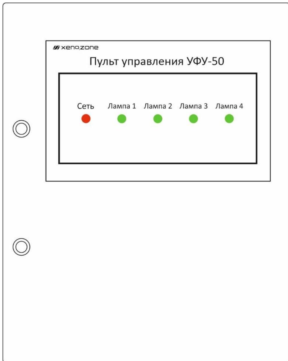
Индикаторные лампочки контролируют работу УФ-ламп. При включении питания (при исправной лампе) индикаторная лампа загорается ярким светом, мигает, далее горит тускло. В остальных случаях установка неисправна.
