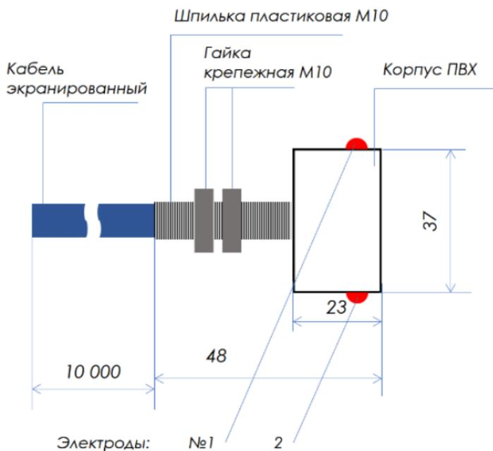
При использовании датчика ДС-1 клеммы блока управления SENSOR №1 и №2 замыкаются соединительным джампером.
